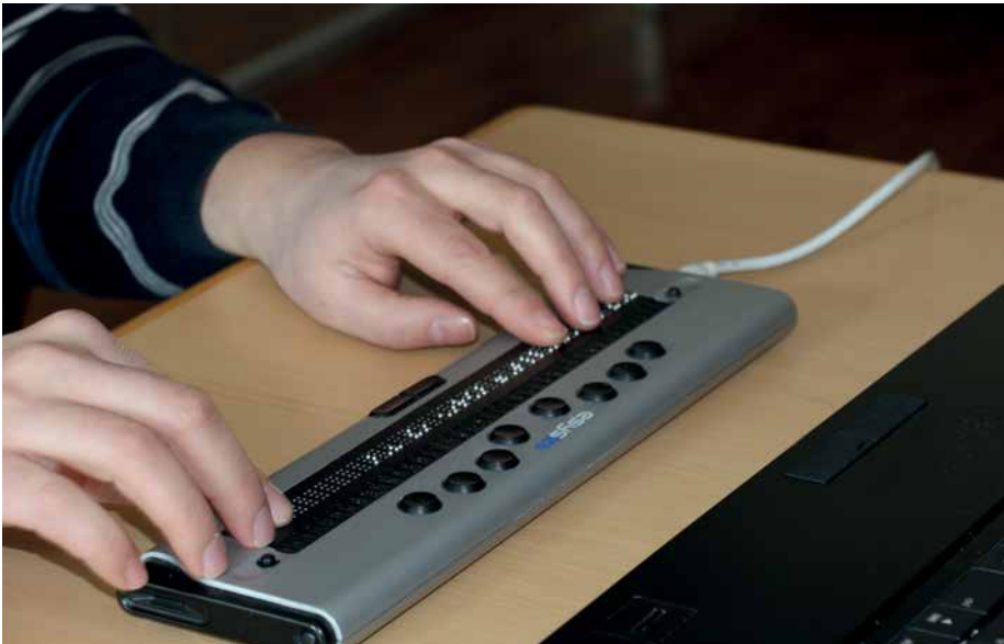
Braillezeile: Mit diesem Computer-Ausgabegerät können blinde Menschen Buchstaben ertasten
